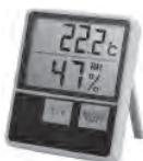
Im Handel gibt es Thermometer (Messung der Wärme) und Hygrometer (Messung der Luftfeuchtigkeit) schon für wenig Geld. Entscheiden Sie sich für ein digitales Gerät (wie Abbildung), nicht für ein analoges. Das digitale Gerät muss nicht geeicht werden. Bei einer Raumtemperatur zwischen 20 und 22 Grad beträgt die ideale Luftfeuchtigkeit 40 % bis 60 %.
